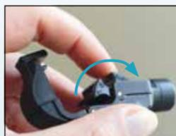
Ouvrir le Stop-Broche et faire tourner la mollette pour sélectionner le diamètre de broche à sécuriser (5, 6, 7 ou 8 mm).
