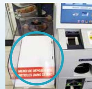
Cette plaque de désactivation (format 345 x 650 mm) est spécifique aux CLS. Elle se connecte au boîtier de désactivation, et est à positionner dans ou sur le côté du bac de récupération produit.
